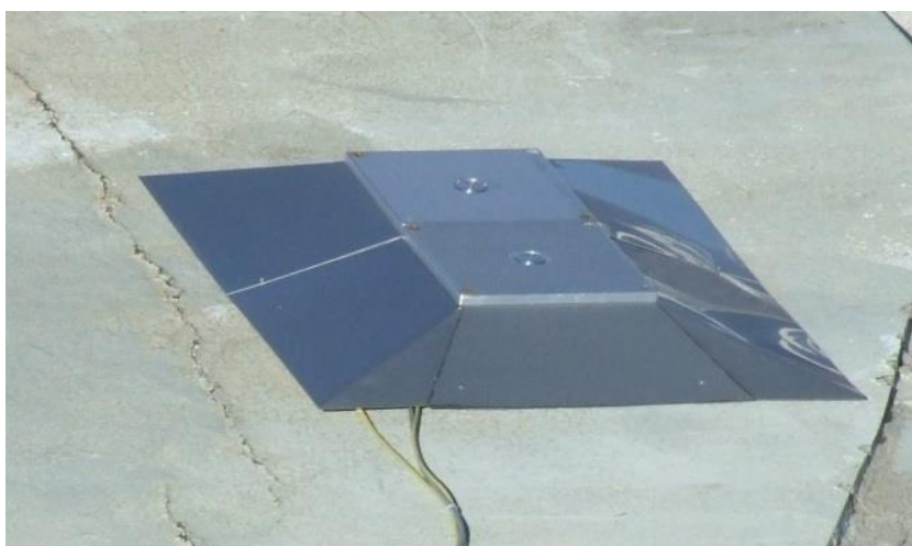
Figure 3.6 : Les antennes « rapide » et « large bande » installées au Pic du Midi.
