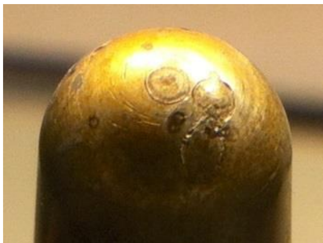
Figure 3.22 : Photo de la pointe du paratonnerre présentant des traces de fusion.
