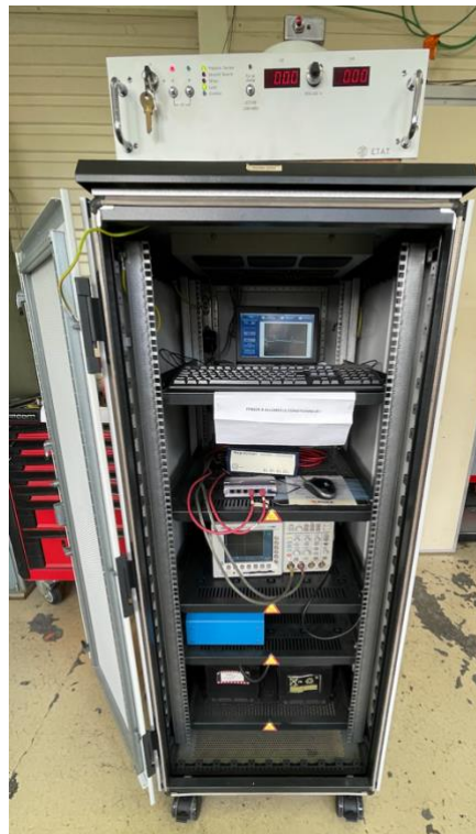
Figure 2.13 : Baie faradisée contenant la chaîne de mesures de pression.
