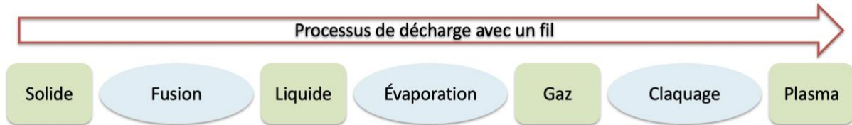
Figure 5.4 : Étapes de changement d'état d'un fil métallique.
