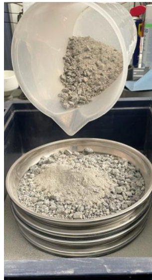
Figure 4.5 : Tamisage d'un échantillon de roches ayant subi un traitement par décharges électriques dans l'eau.
