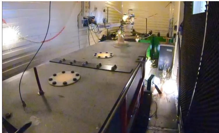
Figure 2.7 : Chambre d'essais durant une décharge électrique.
