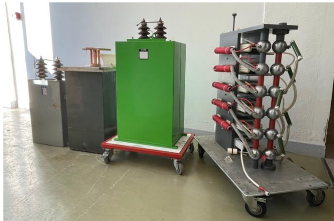
Figure 2.8 : Différentes capacités utilisées lors des essais. De gauche à droite : C = 1,4 \mu F , C = 3,9 \mu F , C = 21,2 \mu F , C_{eq} = 33 \text{ nF} .
