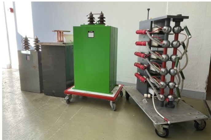
Figure 2.8 : Différentes capacités utilisées lors des essais. De gauche à droite : C = 1,4 \mu F , C = 3,9 \mu F , C = 21,2 \mu F , C_{eq} = 33 nF .
