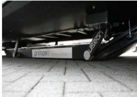
Figure I-13 : La bobine primaire lors de son rapprochement au sol avec son système de refroidissement [32].
