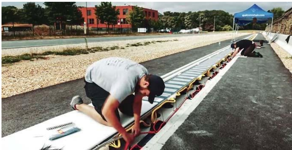
Figure I-19 : Piste d'essai de la technologie Qualcomm en dynamique [39].
