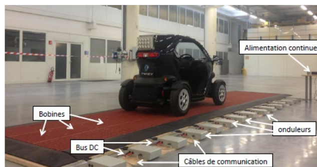
Figure I-16 : Prototype de la piste routière conçue dans la thèse [28].
