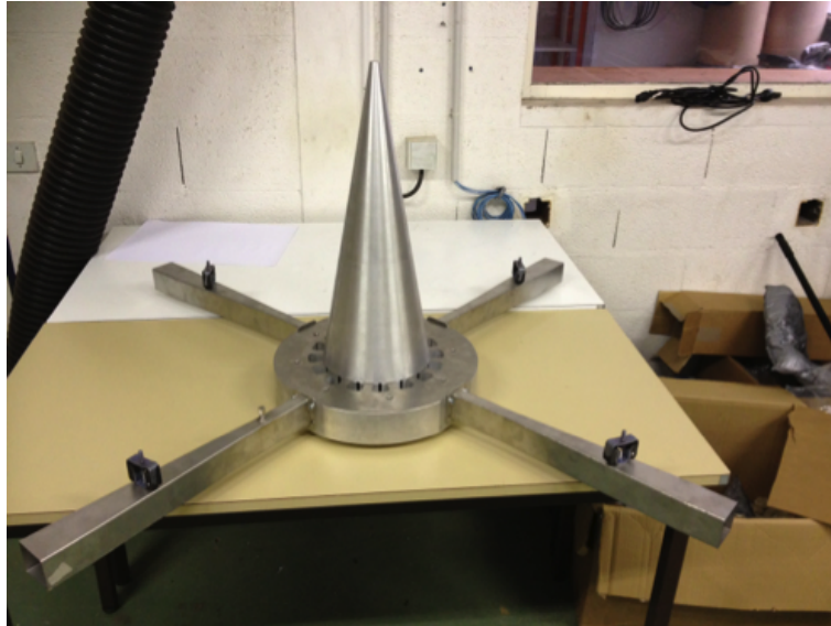
FIGURE 3.3 – Photographie du banc d'essai. Vue globale du système de refroidissement incluant les quatre branches d'où l'écoulement arrive.
