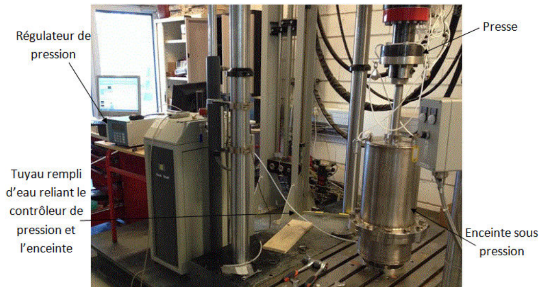
FIGURE 2.48 : Dispositif de l'essai lors de l'essai sous pression d'eau liquide.
