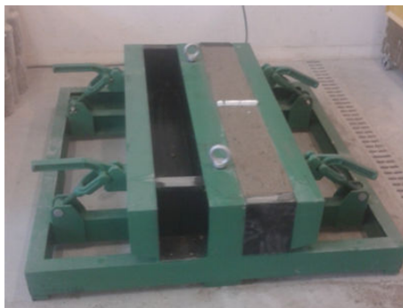
FIGURE 2.5 : Coffrage métallique des mini poutres.
