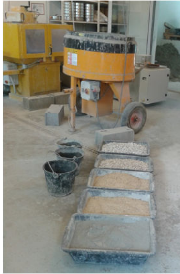
FIGURE 2.3 : Vue des différents ingrédients et du malaxeur
