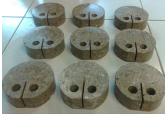
FIGURE 2.14 : éprouvettes d'essai DCT.
