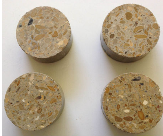
FIGURE 2.19 : éprouvettes essai TPS.
