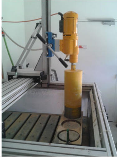
FIGURE 2.6 : Carottage des poutres.
