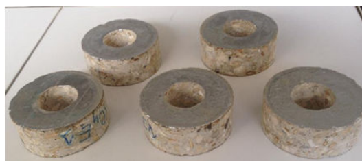
FIGURE 2.18 : éprouvettes essai de perméabilité.
