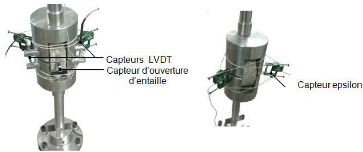
FIGURE 2.41 : Dispositif de l'essai DCT.
