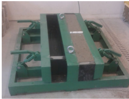
FIGURE 2.5 : Coffrage métallique des mini poutres.
