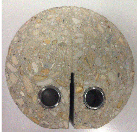
FIGURE 2.17 : éprouvette DCT après rectification.
