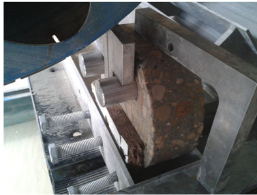
FIGURE 2.11 : Réalisation de l'entaille.
