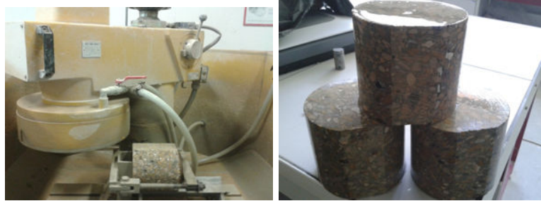
FIGURE 2.7 : Réalisation du méplat.
