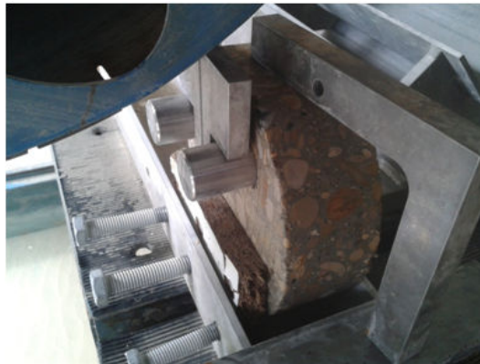
FIGURE 2.11 : Réalisation de l'entaille.
