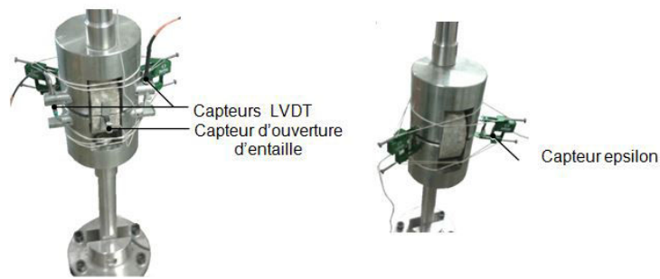
FIGURE 2.41 : Dispositif de l'essai DCT.
