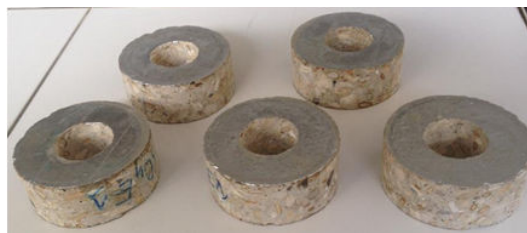
FIGURE 2.18 : éprouvettes essai de perméabilité.
