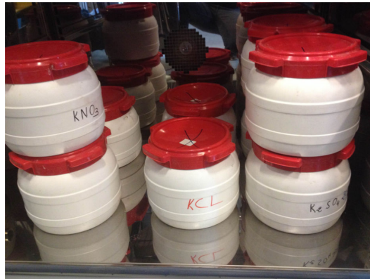
FIGURE 2.20 : Mise en équilibre des éprouvettes dans des bacs étanches contenant des solutions salines dans une enceinte à 60 °C
