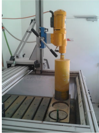
FIGURE 2.6 : Carottage des poutres.
