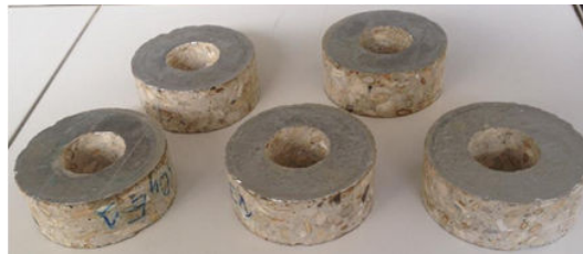
FIGURE 2.28 : Éprouvettes de l'essai de perméabilité
