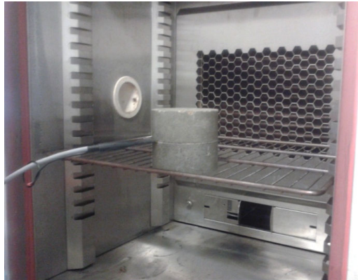
FIGURE 2.25 : mesure des propriétés thermiques selon la méthode "TPS" dans l'enceinte climatique à 30 et 90 °C.
