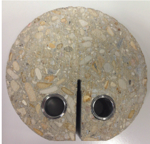
FIGURE 2.17 : éprouvette DCT après rectification.
