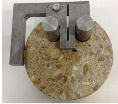
FIGURE 2.10 : Perpendicularité entre les faces principales et les axes des deux trous
