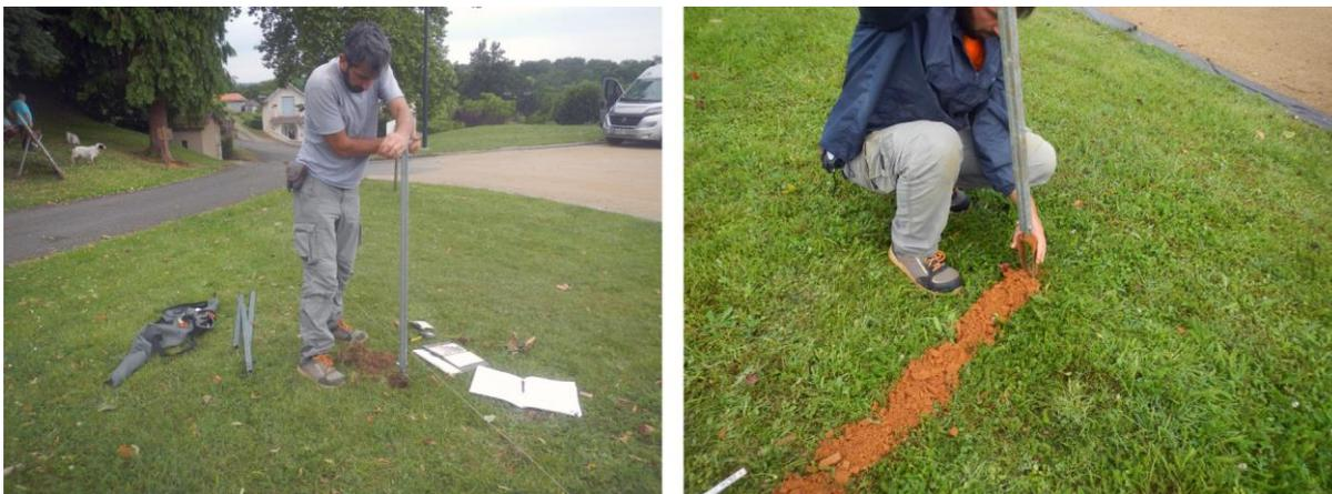
Fig. 40 - Réalisation de forages à l'aide d'une tarière manuelle et documentation des caractères sédimentaires des séquences rencontrées
