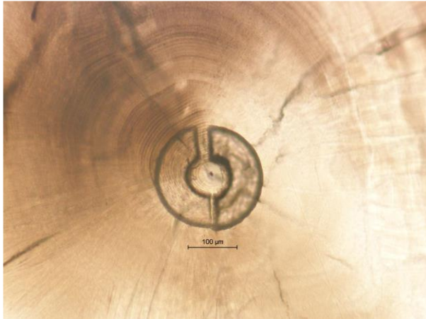
Figure 1 : Photo de la zone centrale d'un otolithe d'aloise ayant fait l'objet de deux ablations avec la stratégie demi-couronne pour analyser le rapport isotopique du Sr ( ^{87}\text{Sr} : ^{86}\text{Sr} ). Chaque demi-couronne a un rayon de 60\mu\text{m} et est positionnée à 40\mu\text{m} du centre de l'otolithe (nucléus), i.e. l'analyse du ^{87}\text{Sr} : ^{86}\text{Sr} intègre la partie de l'otolithe située entre 40 et 100\mu\text{m} du nucléus. Photo tirée de Martin et al. (2015)
