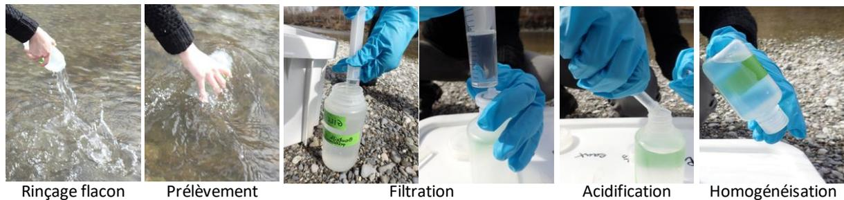
*Figure 3 : étapes du protocole de prélèvement d'eau.*
