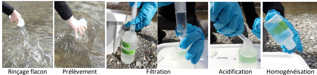
Figure 3 : étapes du protocole de prélèvement d'eau.
