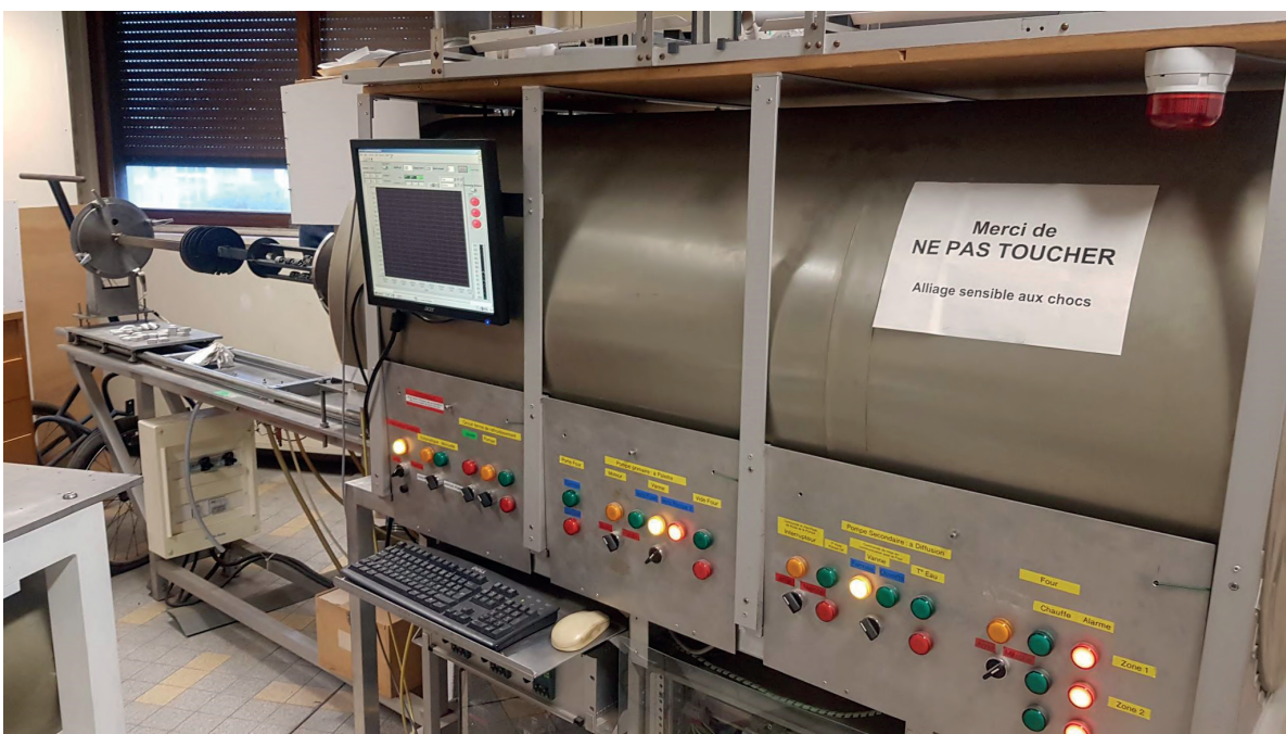
Figure : Four à paléointensité avec positionnement des échantillons selon la direction du champ appliqué
