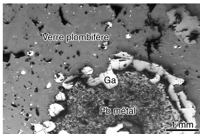
Figure 3 : Microphotographie de scorie en lumière réfléchie : nodule de plomb métal, entouré de galène (Ga) au sein de la matrice de verre plombifère.
