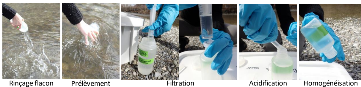
Figure 3 : étapes du protocole de prélèvement d'eau.
