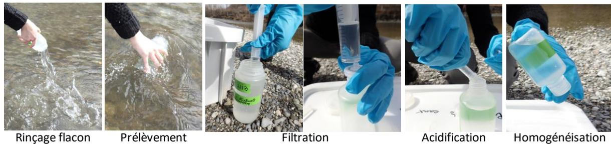
Figure 2.4 : étapes du protocole de prélèvement d'eau.
