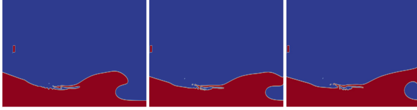
FIGURE 6 – Impact avec air emprisonné obtenu pour h_0 = 18mm et X_0 = 0.7m à t = 0.2728, 0.3045 et 0.3183 s.
