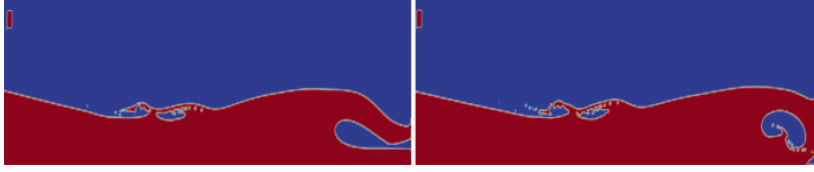
FIGURE 7 – Impact obtenu après la rupture totale de la vague pour h_0 = 18mm et X_0 = 0.80m à t = 0.3639 et 0.3861s .
